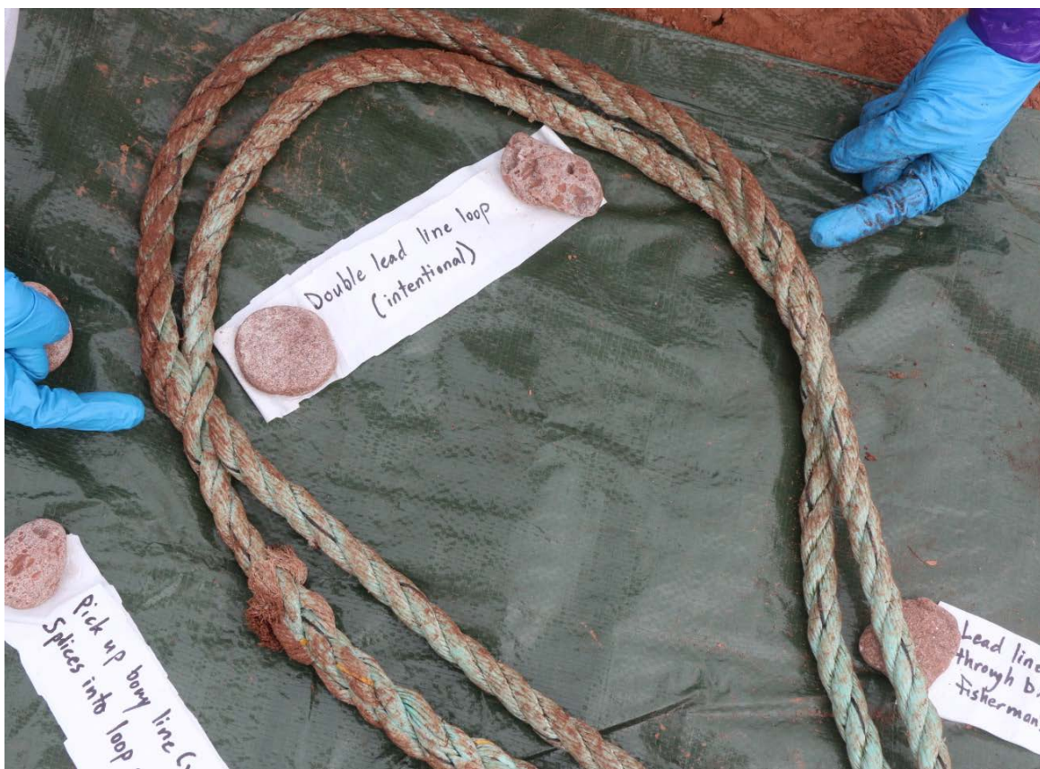
Figure 15. Ligne plombée doublée sur elle-même et glissée entre un brin à plusieurs endroits à la place d'un nœud.
